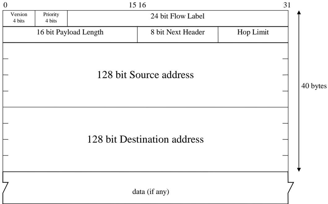
**Figure 20. The IPv6 header**
